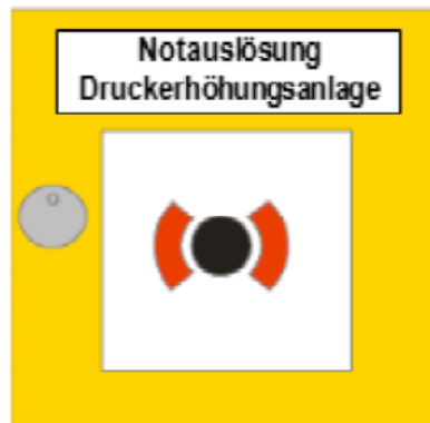
Abbildung 1: Handansteuereinrichtung zur Notauslösung der DEA.
