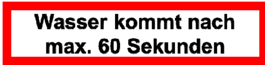
Abbildung 4: Hinweisschild für verzögerte Wasserbereitstellung bei Löschwasseranlagen „nass/trocken“.
